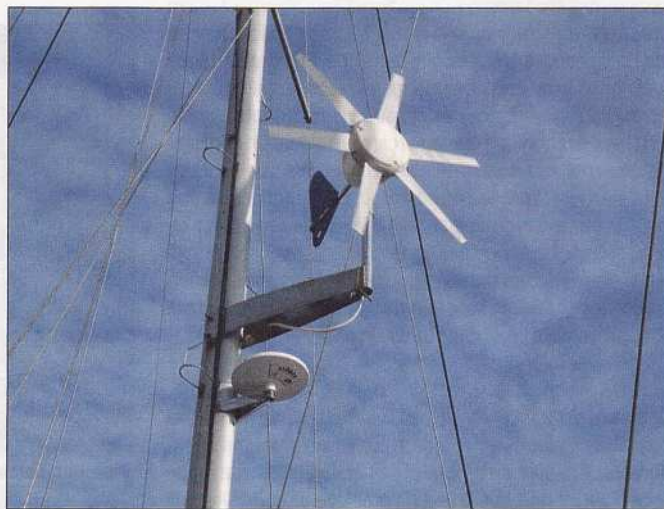
Éolienne sur mât © Figaro Nautisme
