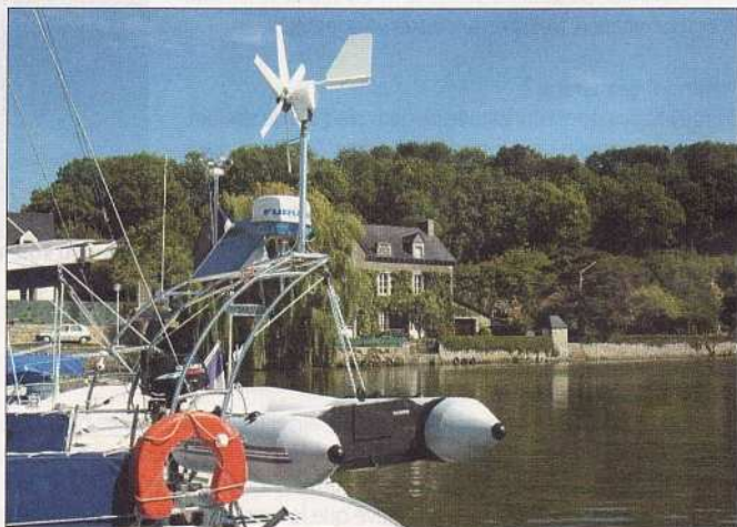
Éolienne à axe horizontal © Figaro Nautisme
