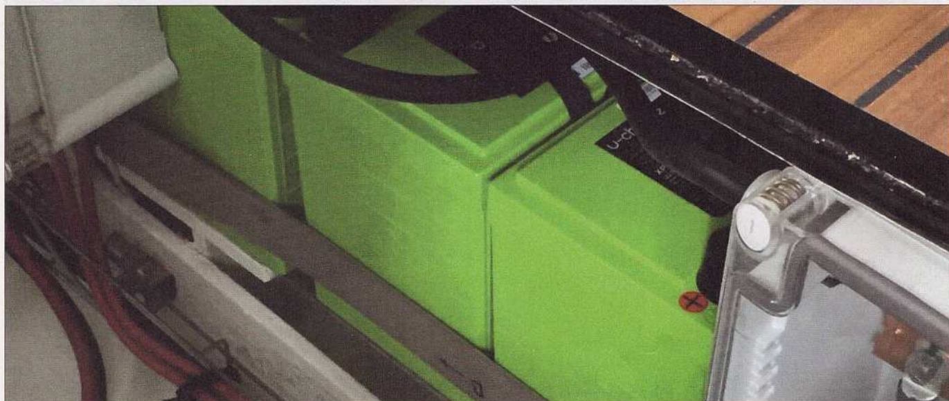
Batterie Lithium-ion sur un bateau électrique © Figaro Nautisme
