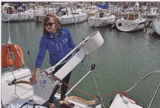
Mise en place hydrogénérateur © Figaro Nautisme
