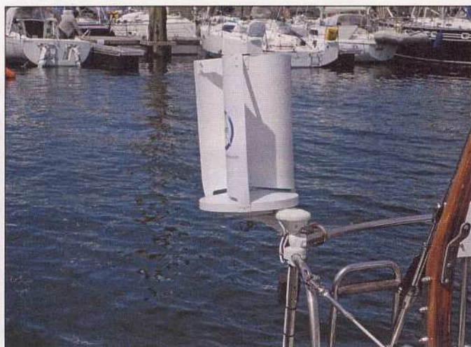
Éolienne à axe vertical © Figaro Nautisme
